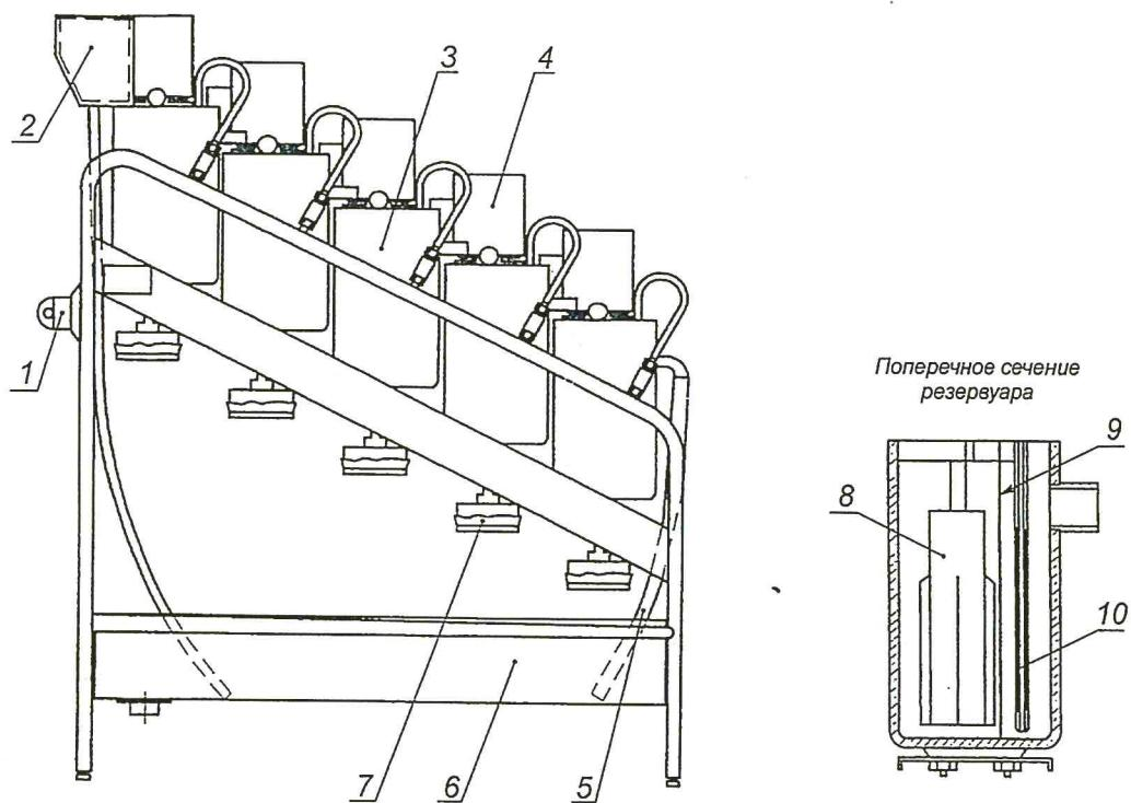
1 — выключатель; 2 — резервуар с постоянным уровнем; 3 — резервуар; 4 — редуктор; 5 — шланг сливной; 6 — поддон для стока; 7 — чаша фильтровальная; 8 — мешалка цилиндрическая; 9 — перегородка внутренняя; 10 — сито
