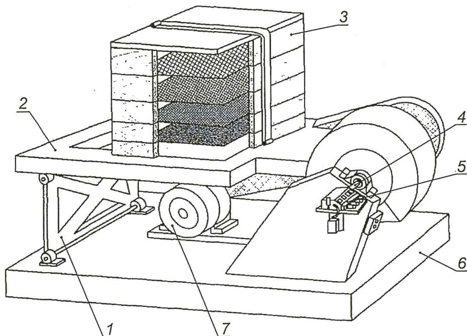
1 — стойка шарнирная; 2 — платформа; 3 — комплект сит; 4 — приводной вал; 5 — счетчик оборотов вала; 6 — станина;
