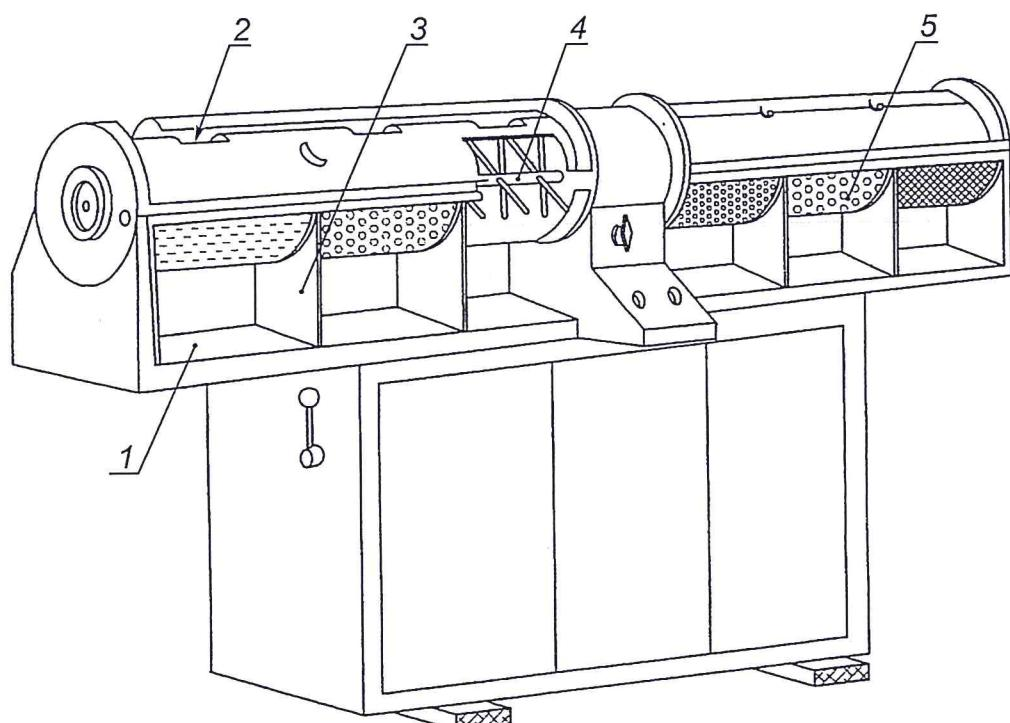
1 — рабочая камера; 2 — загрузочная воронка; 3 — перегородка; 4 — вал с колодками; 5 — сите
