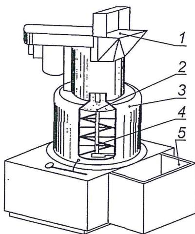
1 — загрузочная воронка; 2 — питатель; 3 — камера рыхления; 4 — вал с колками; 5 — емкость для разрыхленной пробы
